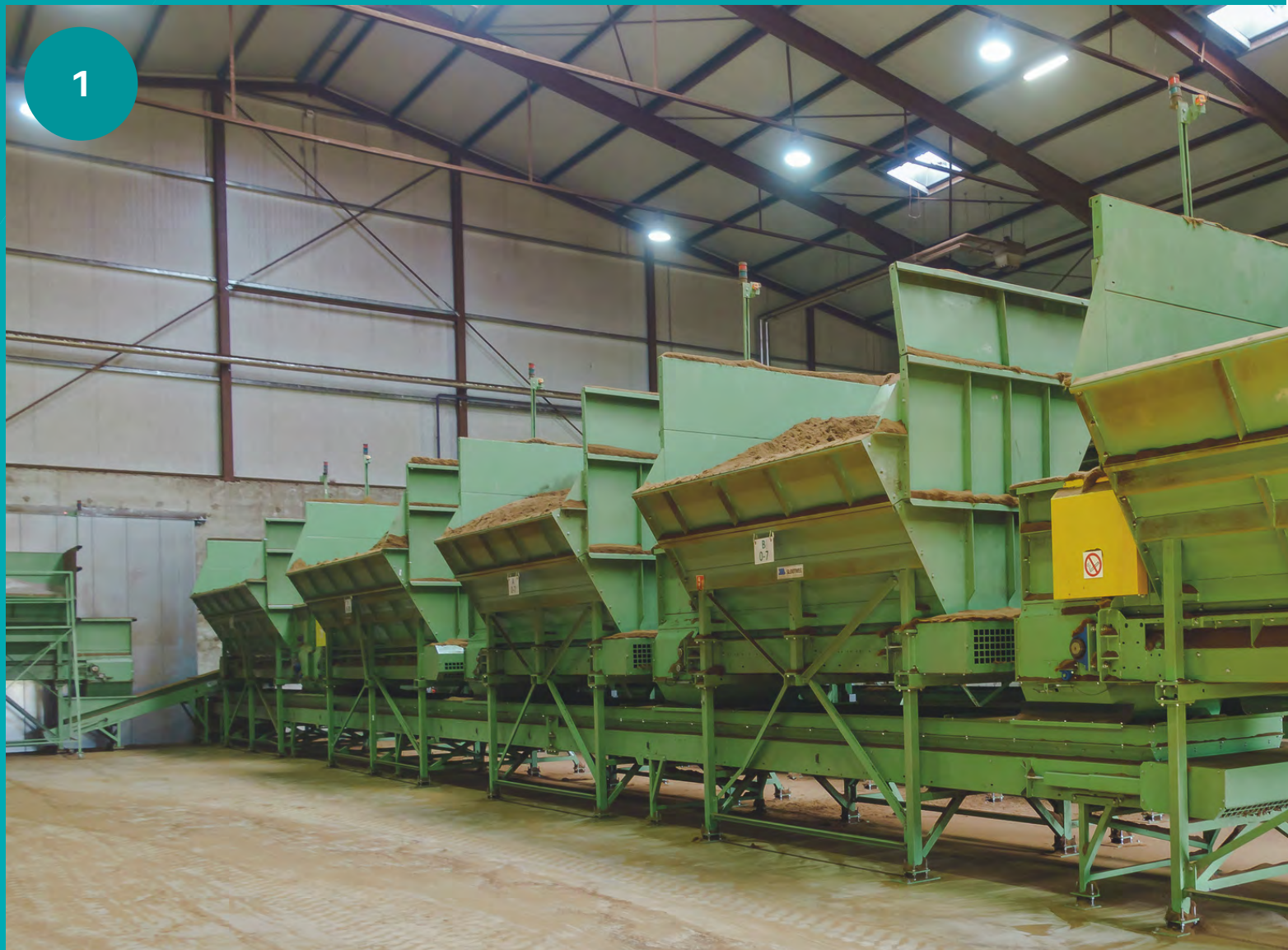
Immagine 1: Miscelazione dei componenti organici e d inorganici con dosatori volumetrici
